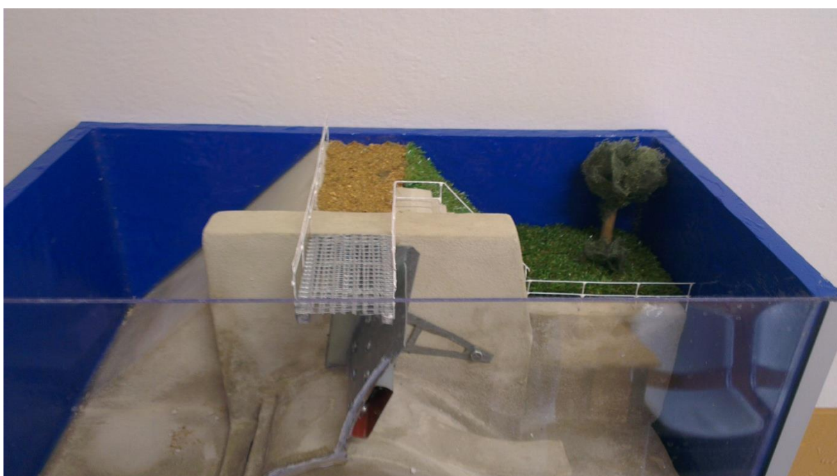
Obr. 5 Pohled ze vzdušného líce hráze bez vody
