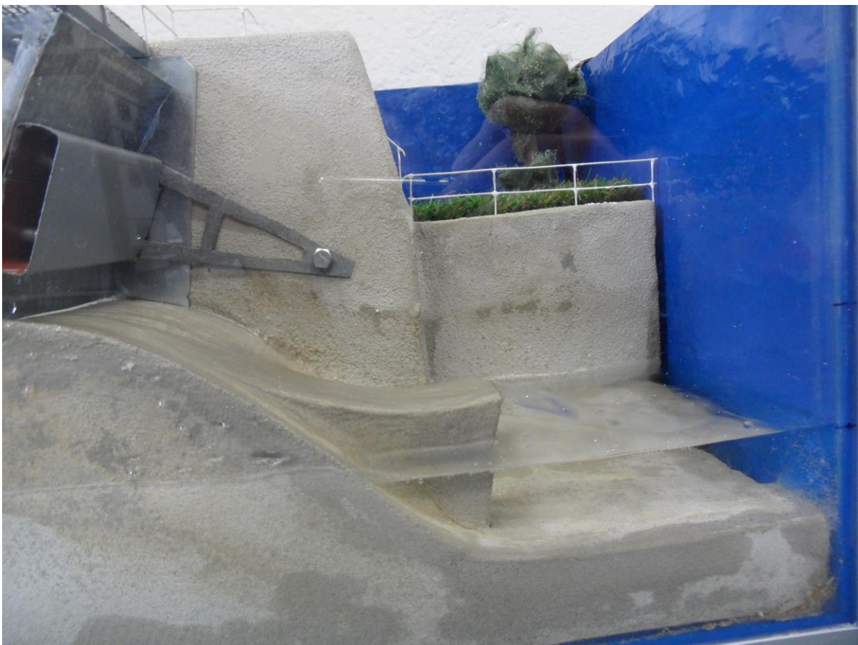
Obr. 8 detail bystrinného proudění na vzdušném líci
